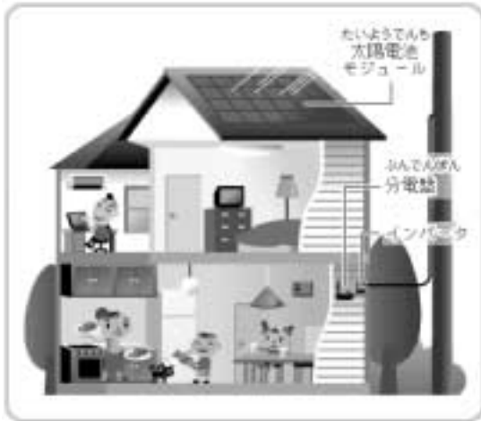
住宅用太陽光発電システム
