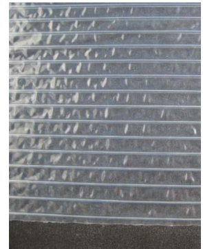
中空構造資材の構造（例）
