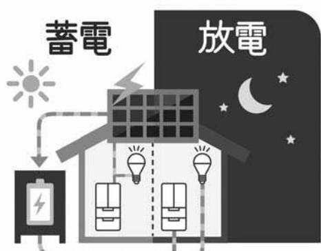
▲卒FIT後は自家消費に有効な蓄電池
