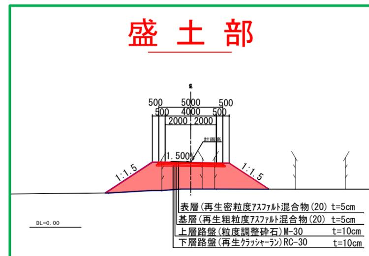
○切土工事を行うため、施工位置図の赤色部分に左の図のように盛土を行い工事用車両の通路を設置します。
